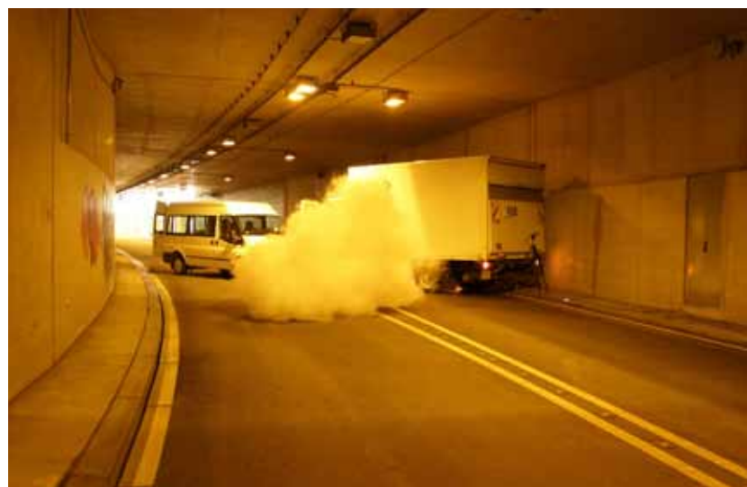
Rauchentwicklung im Tunnel: Das Projekt SKRIBT erforscht praxisorientierte Sicherheitslösungen. Dazu gehören unter anderem neue Gefahrguterkennungssysteme und spezielle Schulungen für ein angemessenes Verhalten bei Tunnelbränden.
